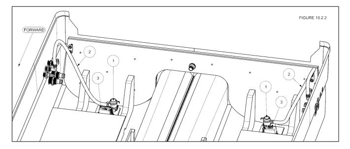
1) BILGE PUMP 2) TO THRU-HULL DISCHARGE 3) FLOAT SWITCH
